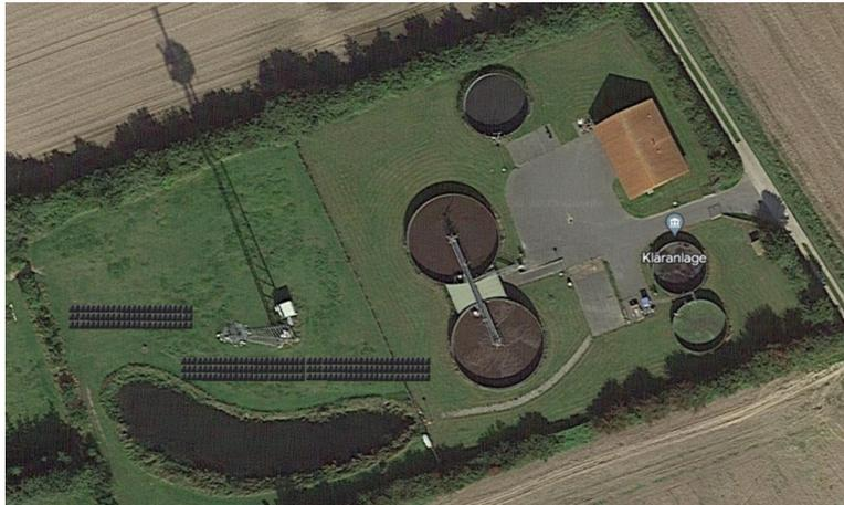
**Bild 1: Beispielhafte Anordnung südlich Funkmast, Platzbedarf für ca. 225 Module (ca. 380 m<sup>2</sup>)**
