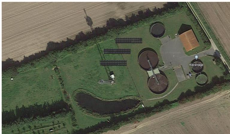
**Bild 2: Beispielhafte Anordnung nördlich Funkmast, Platzbedarf für ca. 200 Module (ca. 340 m<sup>2</sup>)**
