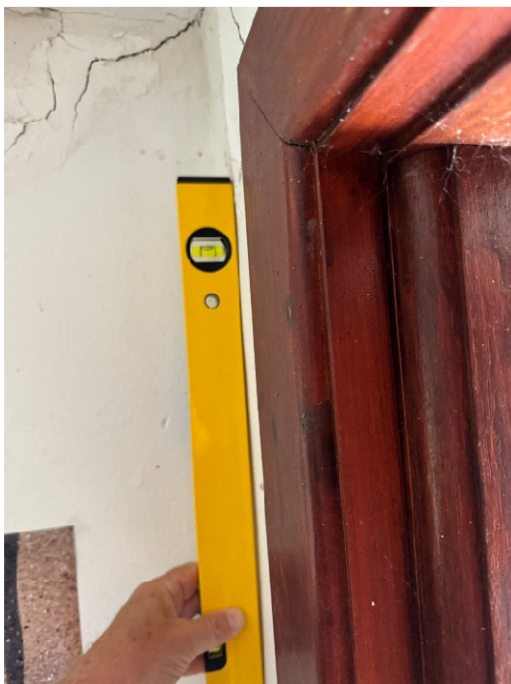
Lotabgleich der Innenwände (12.06.2024)
